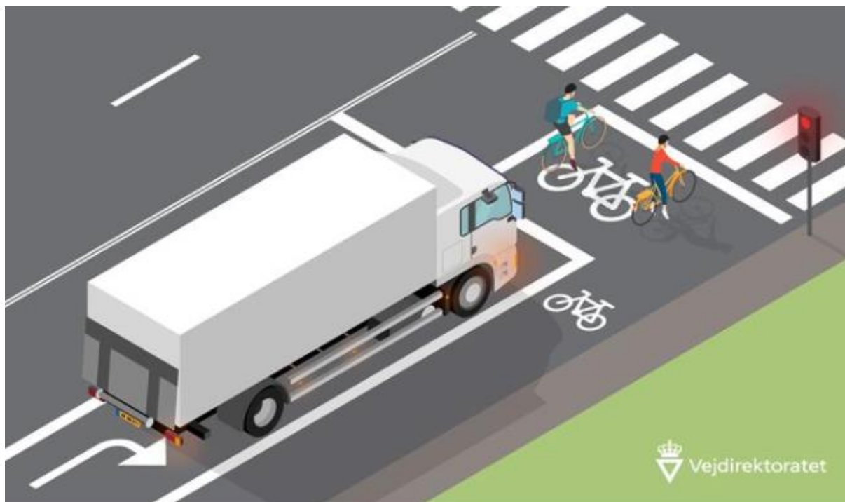
MYND 7 Hólf fyrir hjólandi vegfarendur við gatnamót þar sem hægri beygja er leyfileg.
